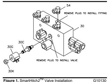
Figure 1. SmartHitch2<sup>TM</sup> Valve Installation
