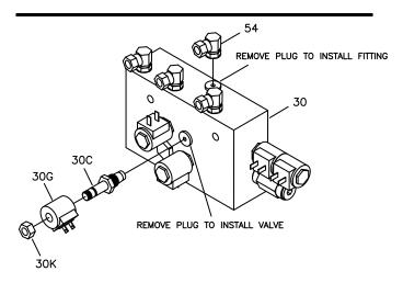
Figure 11. SmartHitch2<sup>TM</sup> Valve Installation
